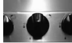
6. Düğmeyi yerinden dikkat ederek çıkarınız, Valf milinin içindeki deliğe uygun düz tornavidayı saat yönünün tersine çevirerek maksimum alev, saat yönünde minimum alev ayarını yapabilirsiniz.
