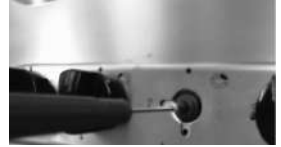
6. Düğmeyi yerinden dikkat ederek çıkarınız, Valf milinin içindeki deliğe uygun düz tornavidayı saat yönünün tersine çevirerek maksimum alev, saat yönünde minimum alev ayarını yapabilirsiniz.
